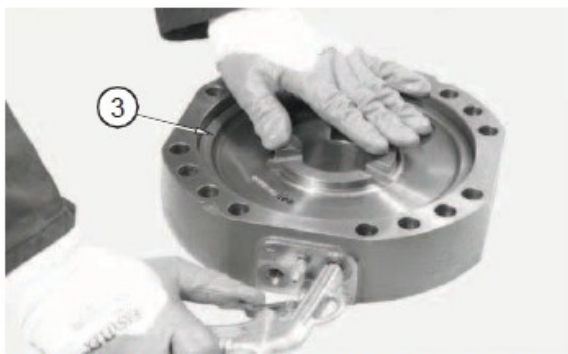
RYSUNEK 13: Powoli wprowadzić sprężone powietrze o niskim ciśnieniu przez element łączący hamulca ujemnego w celu wyjęcia tłoka (3).
